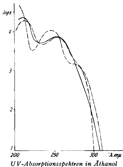
UV-Absorptionsspektren in Äthanol ——— 2a-Methyl-tetrahydronaphtostyryl (XXI, \lambda_{max} 212, 253 \mu ( \log \epsilon = 4,37 bzw. 3,88)). - - - - - Tetrahydronaphtostyryl (IX), \lambda_{max} 213, 255 \mu ( \log \epsilon = 4,28 bzw. 3,85). - · - · - Oxindol.
